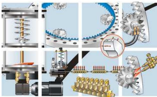
***Sistemi di lubrificazione per centrali eoliche.***
