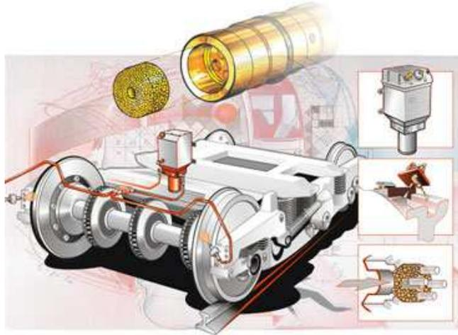
**Lubrificazione Fluilub per bordini e sistemi di manutenzione delle rotaie.**
